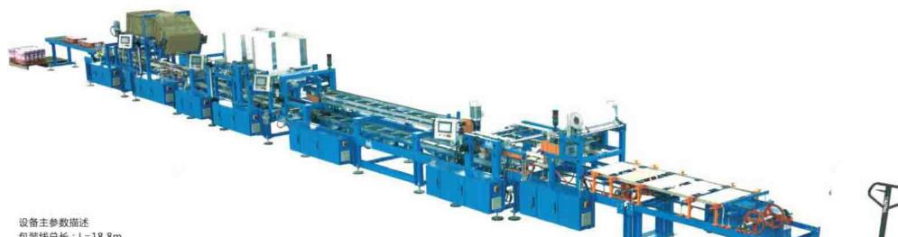
包装线总长: L=18.8m 总装机功率P=11.5KW
